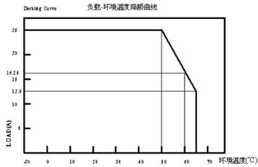
2. 负载电流—环境温度降额曲线 (24V 输出电压) :
